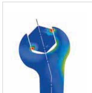
Zonas de carga en las llaves para tornillos y tuercas de STAHLWILLE
