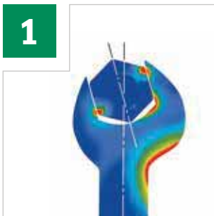
Zonas de carga en las llaves para tornillos y tuercas convencionales
