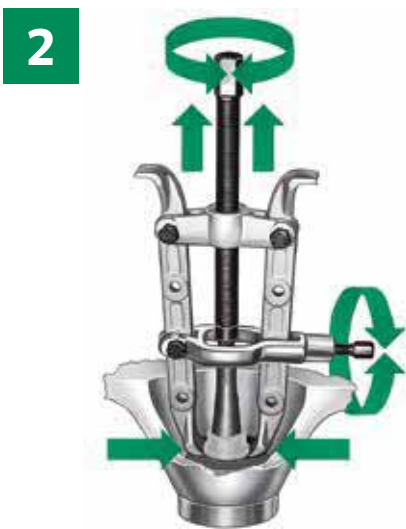
2 Principio de funcionamiento de un extractor de dos brazos
