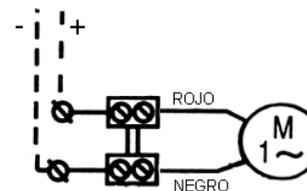
Figura 3 : Conexión eléctrica
