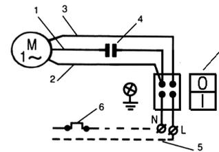
Figura 3 : Conexion monofásica
